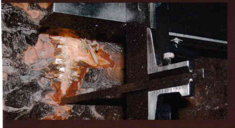
Nach einem Schussversuch: Treffererfassung an einem beschossenen Baumstamm
