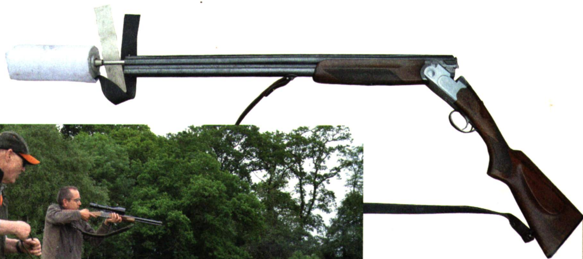
Dummy Launcher: Über einen Einstecklauf kann mit der Flinte ein Dummy abgeschossen werden.
